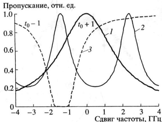
Рис. 5. Относительное расположение линий усиления активной среды CO 2 -лазера при P = 1 атм, пропускания фильтра-пробки при P = 7.5 Тор и аппаратная функция эталона Фабри-Перо. Контур линии усиления CO 2 – 1; аппаратная функция Фабри-Перо – 2; пропускание поглощающей кюветы – 3.
